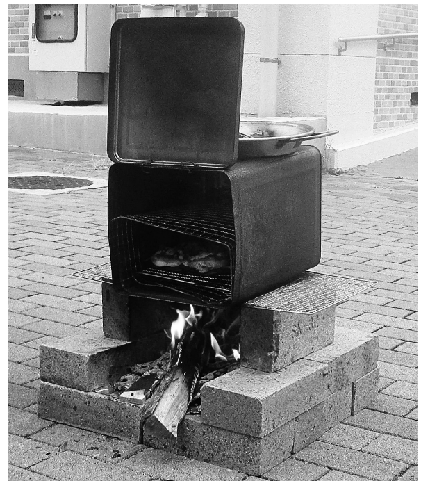
図2 耐火煉瓦による簡易竈
